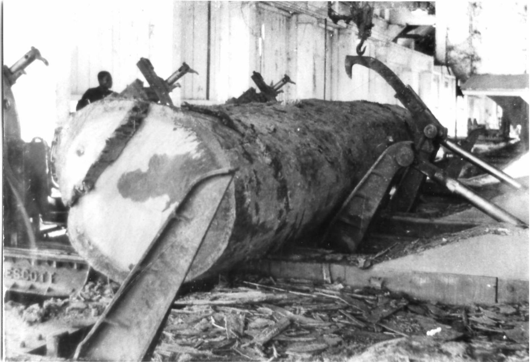
Retournement d'une bille d'acajou à l'aide du chargeur « Hog Tourneur » sur la scie à grumes type PRESCOTT 10 pieds
