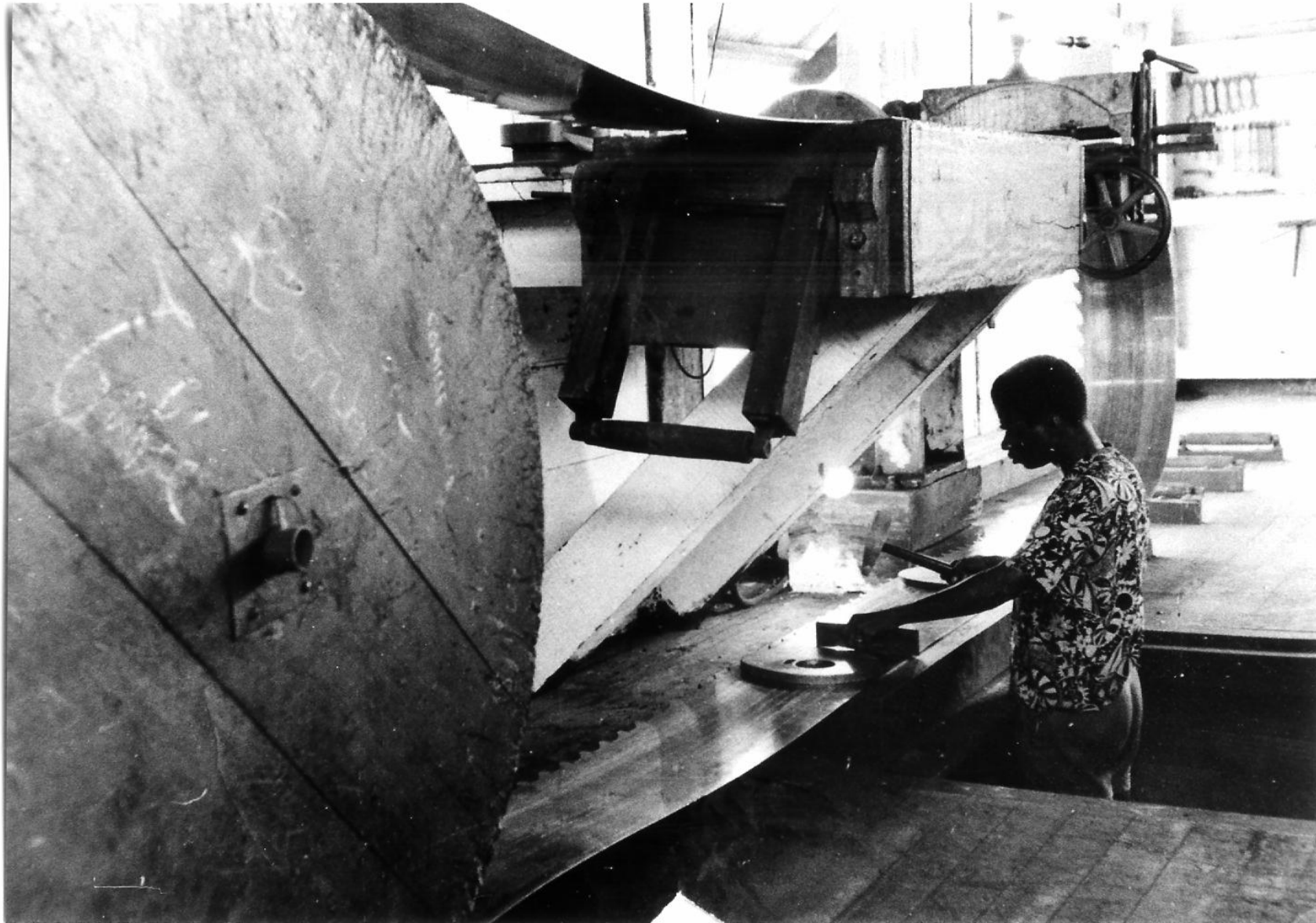
Planage par un Camerounais d'une lame ruban sur la face intérieure sans avoir besoin de retourner l'outil. Une trappe et un second banc de planage suffisent. Douze à treize affûtages sont faits avant d'intervenir sur le corps
