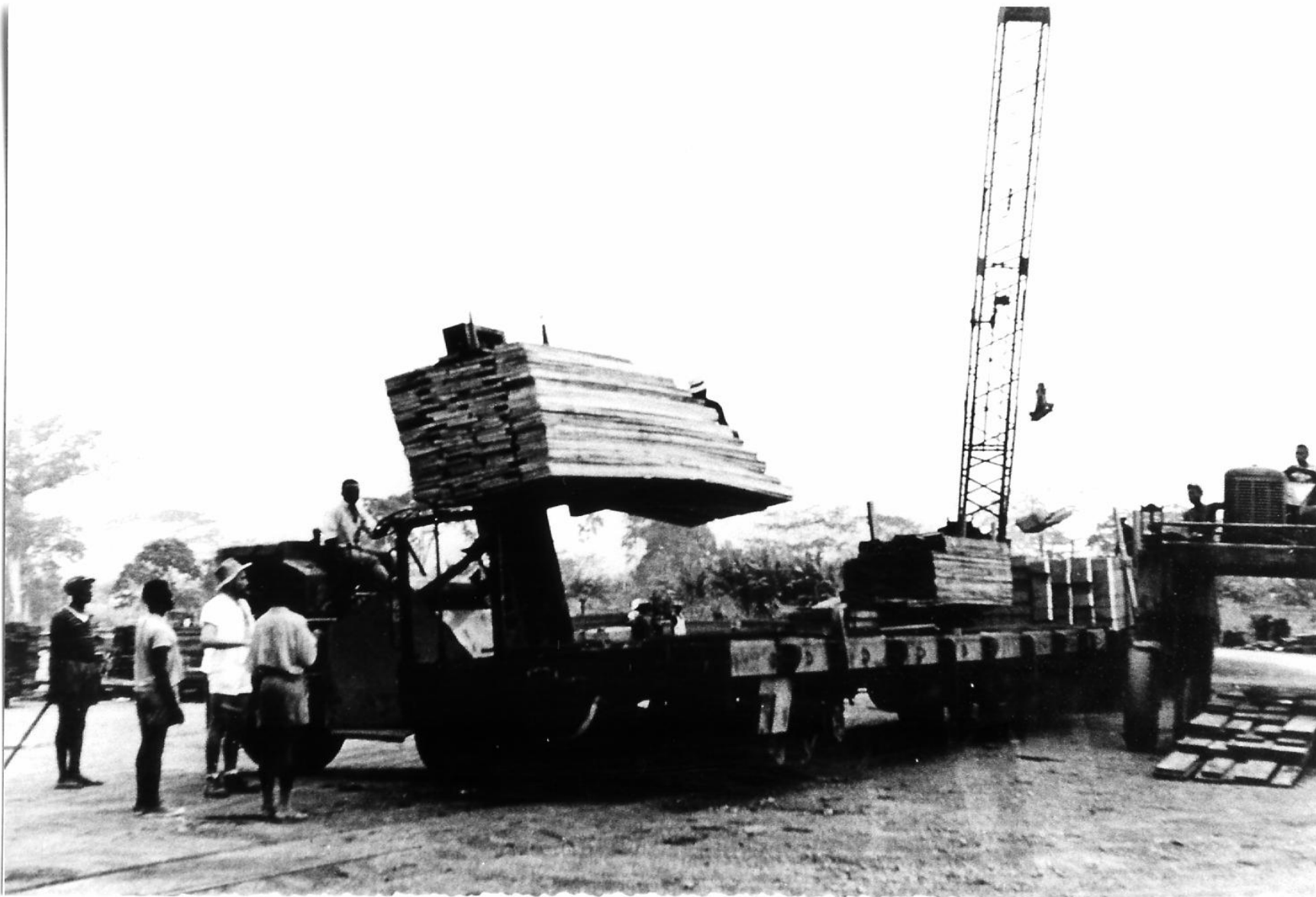
Train rentrant dans la scierie et chargement des wagons à l'aide du chariot élévateur frontal et le Stradel de type HISTER. Destination Douala et son port à 300 kilomètres puis vers la France et l'Amérique
