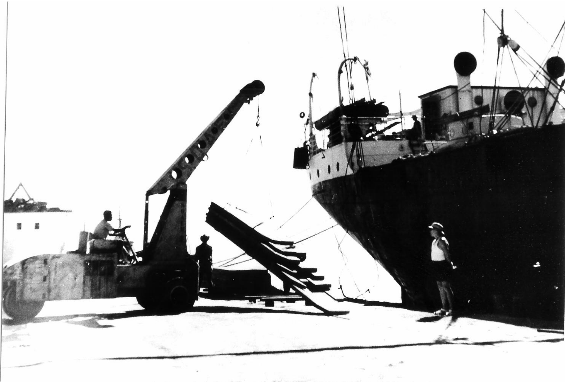
Chargement des paquets de sciages avec un chariot grue de type SOAEMG sur un bateau cargot à Douala
