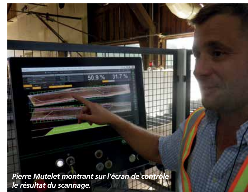
Scannage des planches avant leur délignage
