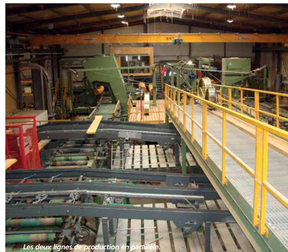
La seconde chaîne d'amenage des billes de hêtre approvisionnant la scie à grumes Primultini
