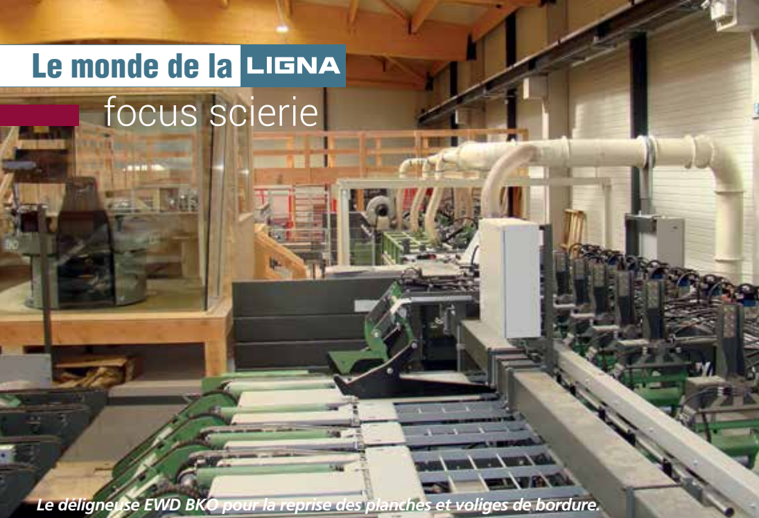
Vue d'ensemble du sciage suspendu avec les bâtis face à face de 1800.
