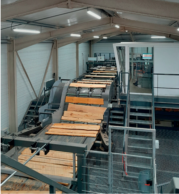
Ligne de délignage automatique ultra rapide EWD, après scannage Microtec, chez FP Bois à Mimizan. De plus en plus de scieries automatisent leur chaîne de production.
