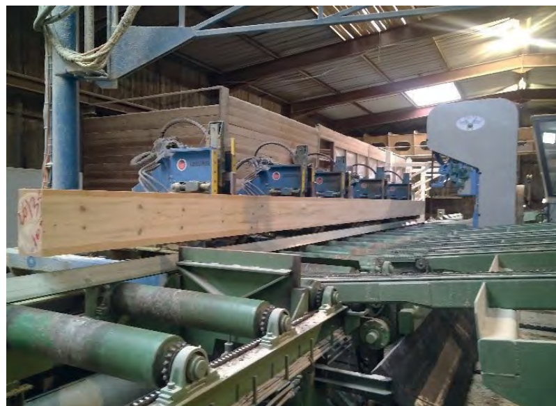
Débit sur liste d'une pièce de charpente de 11 ml.
