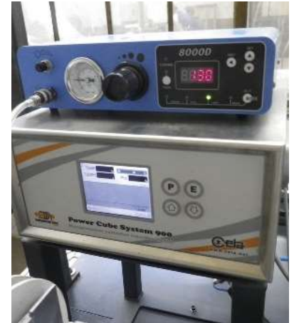
Doseur volumétrique pour un dosage précis de la pâte à braser, générateur de fréquence CEIA pour la chauffe induction.
