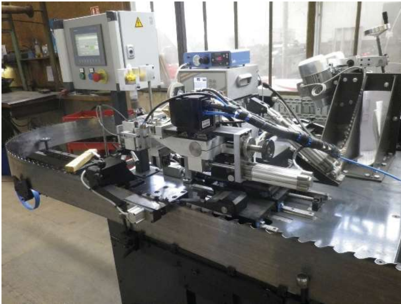
Vue d'ensemble de la tête de brasage et du pupitre de commande.
