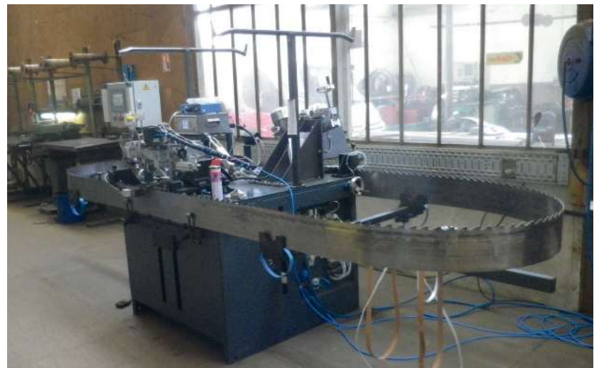
Vue d'ensemble de la machine avec une lame 206 x 1,47 installée dessus.
