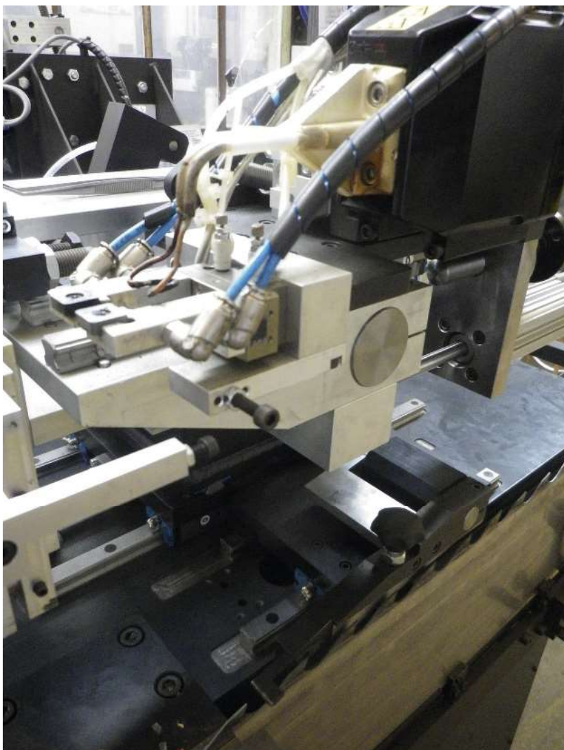
Pince de brasage avec circuit de refroidissement et inducteur de chauffe escamotable.
