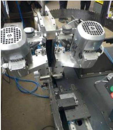
Vue d'ensemble de la tête de rectification à l'arrière de la machine, deux meules diamant pour la réparation des dents.
