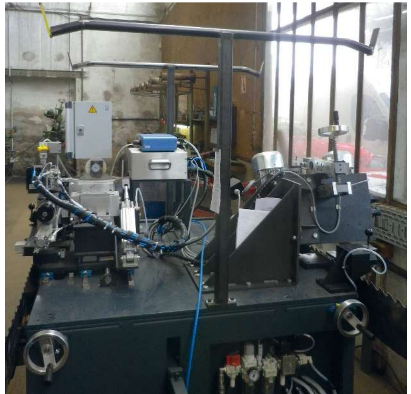
Archet d'introduction pour faciliter la manipulation des lames lourdes et larges.
