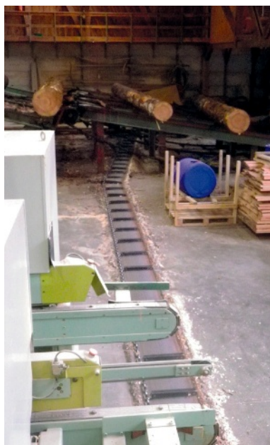
Raclage canalisé au sol, scierie Boudon, un moyen simple pour évacuer au fur et à mesure les déchets générés par l'activité.
