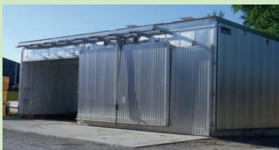
le séchoir Cathild pour abaisser le % d'humidité des avivés à 12%.
