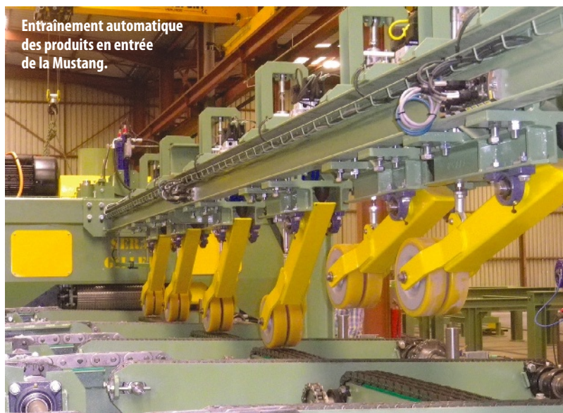
Un des taquets de positionnement automatique et latéral des produits.
