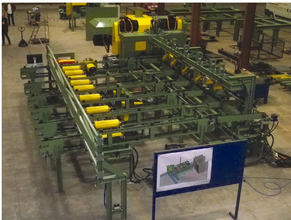
Vue d'ensemble de la Mustang canter 4.0 Sera-Gillet à entrée automatique qui fonctionnera dès l'automne dans une scierie franc-comtoise de résineux.
