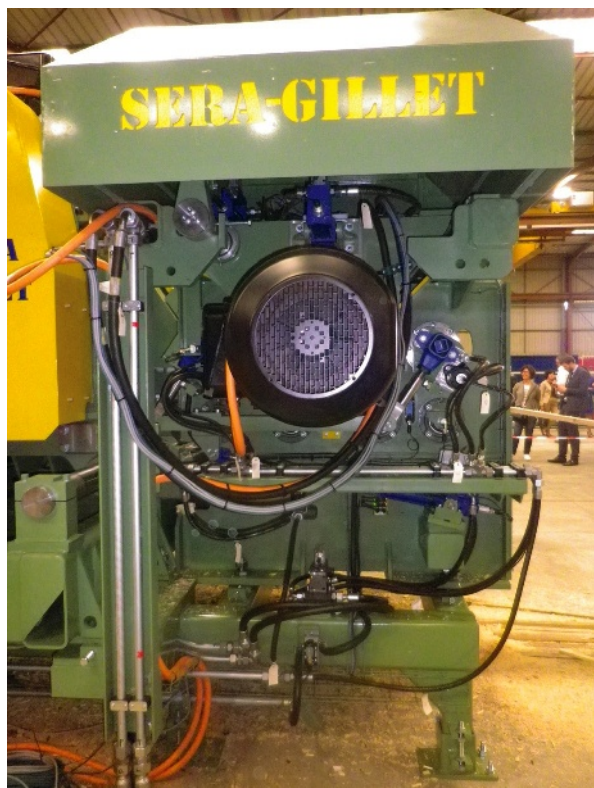
Entraînement automatique des produits en entrée de la Mustang.
