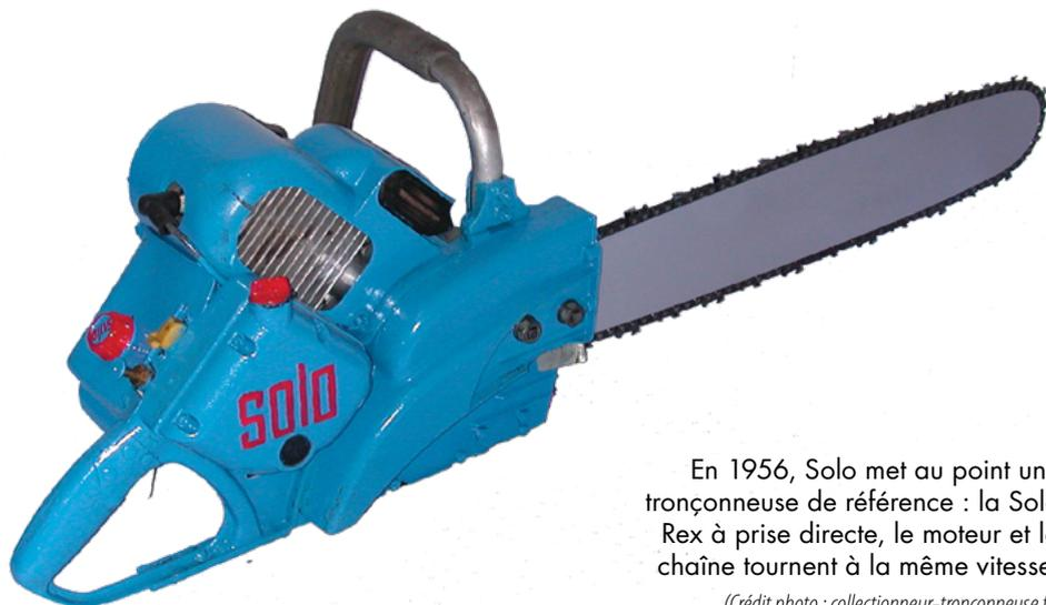
En 1956, Solo met au point une tronçonneuse de référence : la Solo Rex à prise directe, le moteur et la chaîne tournent à la même vitesse.
