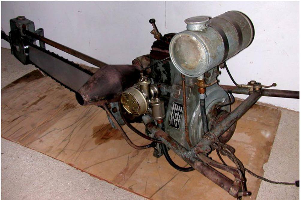
pour tronçonner, car le carburateur à flotteur ne permet pas de mettre le moteur à plat.
