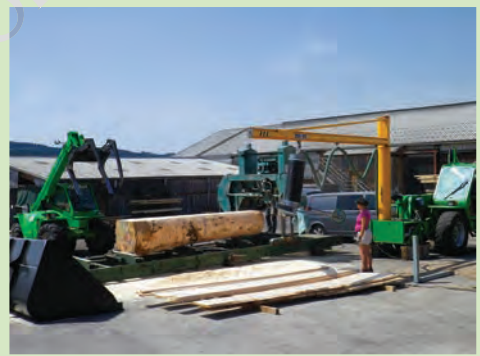
Débit d'une grosse bille et manutention avec une ventouse sur potence.
