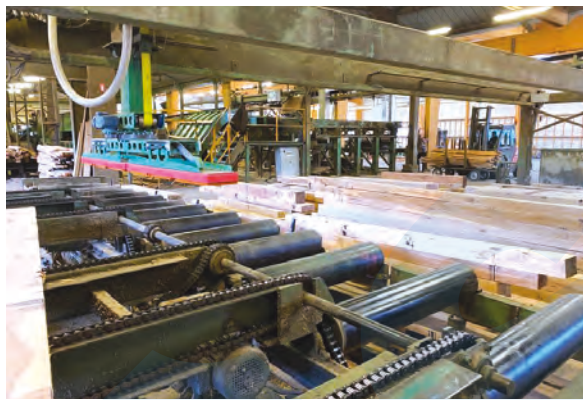
Système d'empilage créé par Joulin avec la tête Mousse-Process en action.
