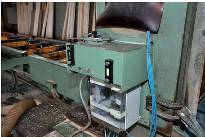
Le réservoir de 15 litres fixé sur le capot de la scie. La lubrification consomme 15 cl d'huile par jour, contre 5 litres de gasoil auparavant.
