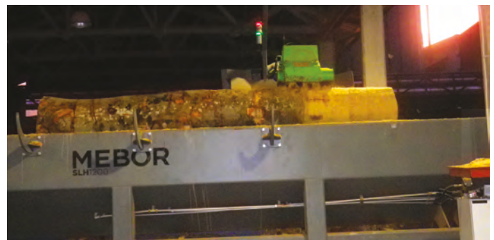
L'écorceuse SLH 1200 pour gros bois à sa tête fraiseuse qui se déplace. Elle pourrait être intégrée directement en tête de chaîne d'aménagement.
