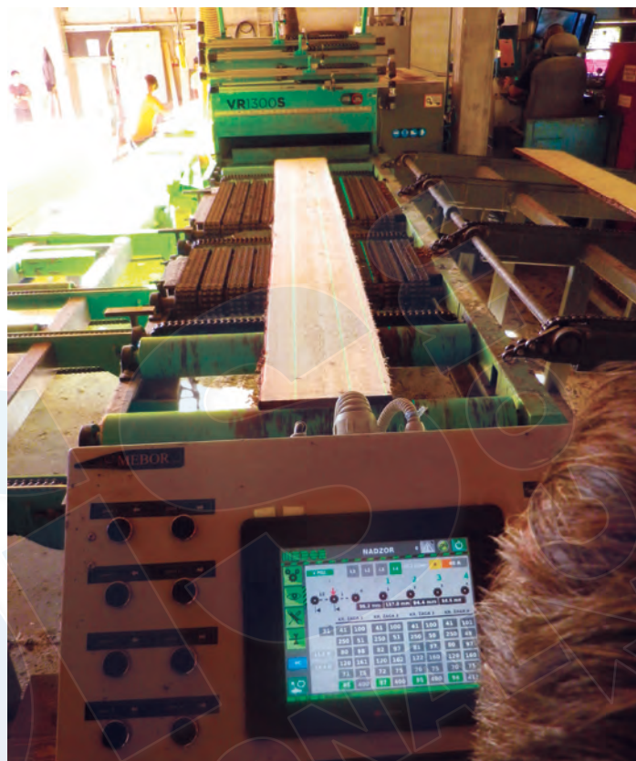
Pilotage en tête de la déligneuse VR 1300 possédant 4 lames mobiles, diamètre 450 mm, d'un côté et de l'autre d'un manchon fixe de 600 mm d'ouverture.
