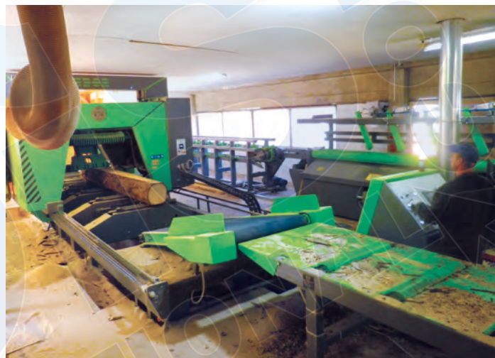
Sortie du ruban horizontal HTZ 1300 PLUS, avec vue sur le tapis qui achemine le bois sur la chaîne longitudinale.
