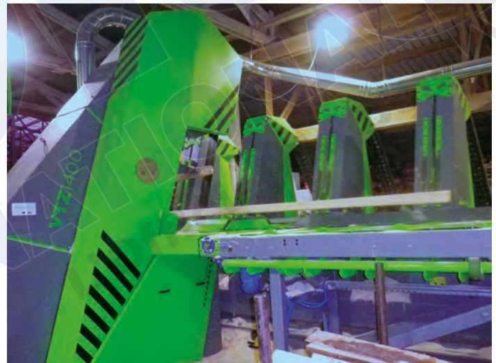
Le ruban vertical VTZ 1400 se caractérise pour son aménagement à chaîne ultra-rapide constaté à 220 m/mn au retour du chariot.
