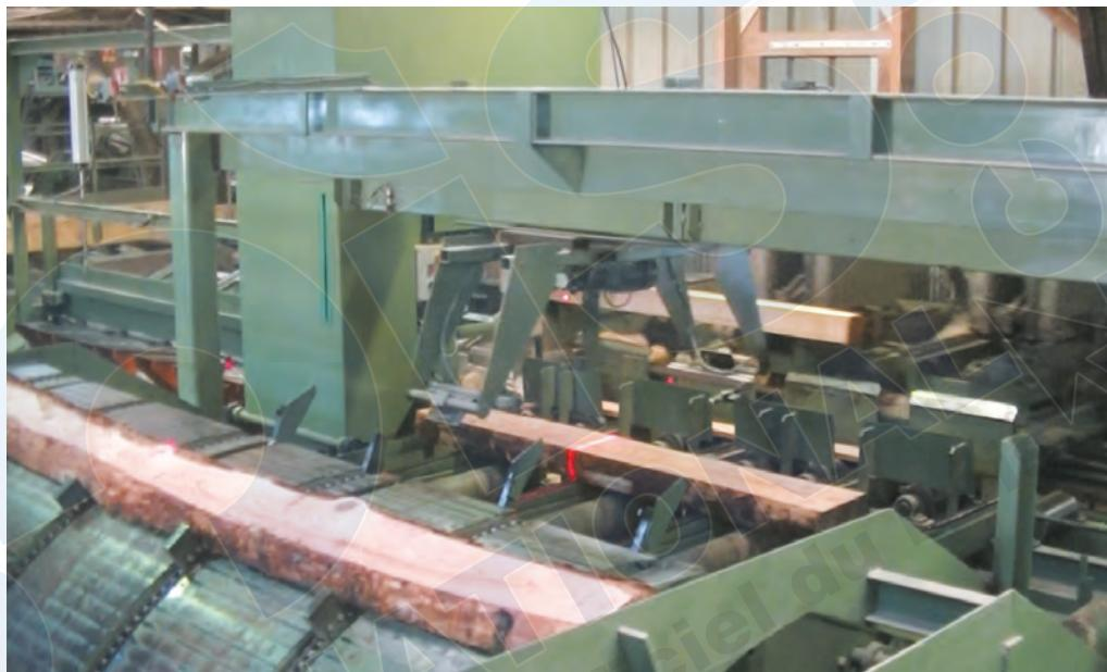
**Vue côté alimentation du scanner en cours d'analyse du plateau. Il s'agit de la préparation en temps masqué pendant que la scie débite seule le précédent plateau.**
