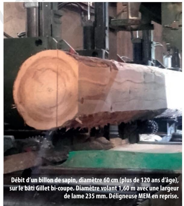
Débit d'un billon de sapin, diamètre 60 cm (plus de 120 ans d'âge), sur le bâti Gillet bi-coupe. Diamètre volant 1,60 m avec une largeur de lame 235 mm. Déligneuse MEM en reprise.
