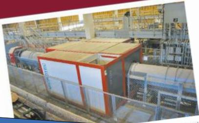
Le scanner CTLog de Microtec autorise le scanage à rayon X du bois pour détecter les défauts qui peuvent être évités avant d'être
