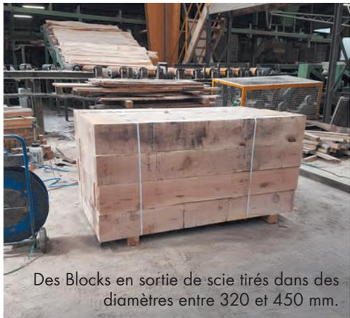
Des Blocks en sortie de scie tirés dans des diamètres entre 320 et 450 mm.
