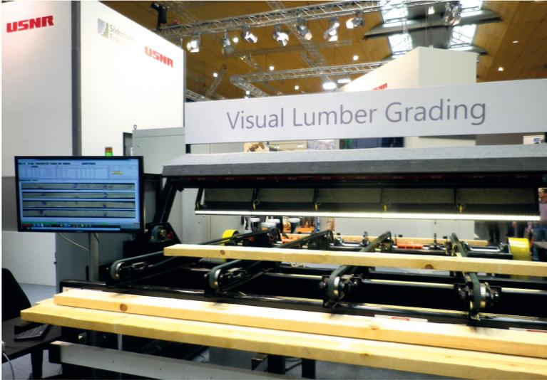
Le groupe Söderhamn Eriksson-USNR, présentait le scanner "Visual Lumber Grading" pour bois vert et bois sec placé avec un trimmer (recoupe de longueur des sciages). Des capteurs sensoriels et deux caméras permettent une reconstitution complète du sciage.
