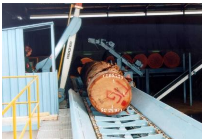
Exemple Poste fixe Hawa dans une scierie de bois exotiques
