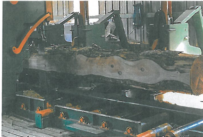
Sciage d'un gros bois sur une scie à grumes LBL-Brenta de diamètre 160 cm à la scierie Lachize, à Thel dans le département du Rhône. LBL-Brenta est le dernier fabricant français; il est situé à Chauffailles en Saône-et-Loire.
