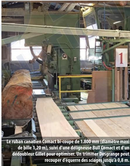
Le ruban canadien Comact bi-coupe de 1.800 mm (diamètre maxi de bille 1,20 m), suivi d'une déligneuse Bull Comact et d'un dédoubleur Gillet pour optimiser. Un trimmer Desgrange peut recouper d'équerre des sciages jusqu'à 0,8 m.
