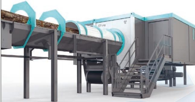
CT Log est le seul scanner tomographique au monde reconstruisant numériquement les caractéristiques internes du billon afin de déterminer la meilleure solution du schéma de sciage en temps réel.
