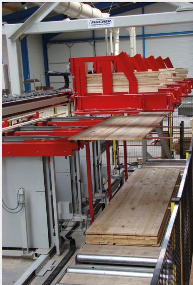
Empilage automatique de produits finis sur une chaîne de rabotage-profilage (parquet, lambris, bardage).
