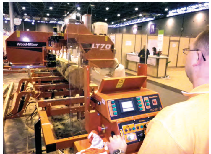
Amélioration du confort d'utilisation chez Wood-Mizer avec l'adjonction du poste de pilotage.
