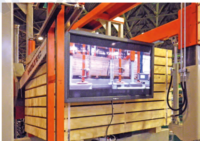
Quatre postes de tronçonnage sont intégrés dans la Quatro de Holtec.
