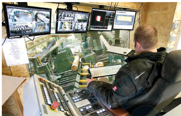
Conduite de la ligne de sciage ruban-déligneuse EWD avec un seul opérateur.
