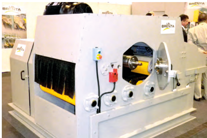
La déligneuse Oxia de LBL acceptant des sciages jusqu'à 150 mm de haut.
