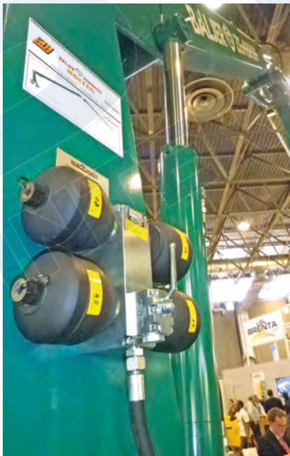
Gros plan sur les accumulateurs d'azote de la grue BZH qui améliorent la souplesse d'utilisation.
