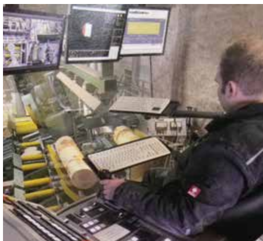
La scierie EWD à un seul opérateur qui dirige toute la ligne de sciage : ruban et centre de reprise.
