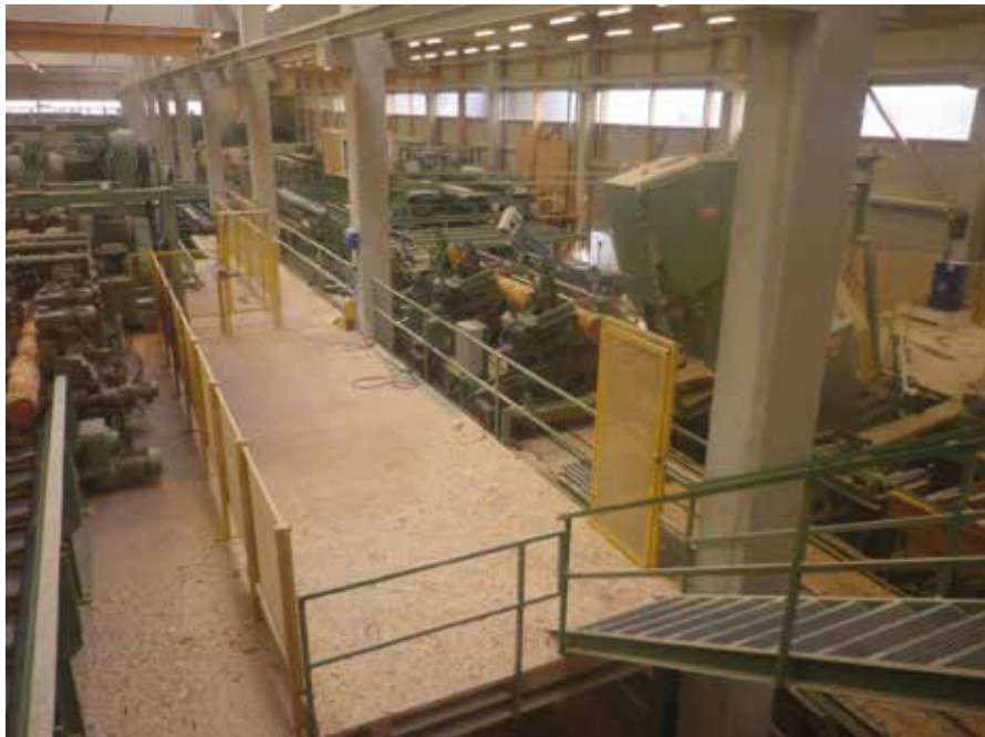
Combinaison récente d'une ligne ruban incliné et d'une ligne canter dans une scierie de résineux du Jura.
