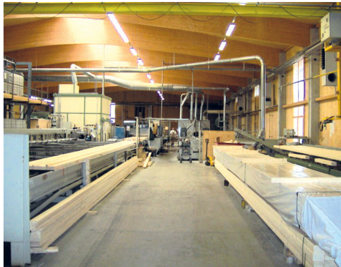
Ligne de fabrication de bois massif reconstitué à la scierie Präbstl.
