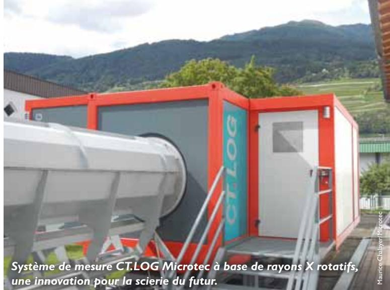
Système de mesure CT.LOG Microtec à base de rayons X rotatifs, une innovation pour la scierie du futur.
