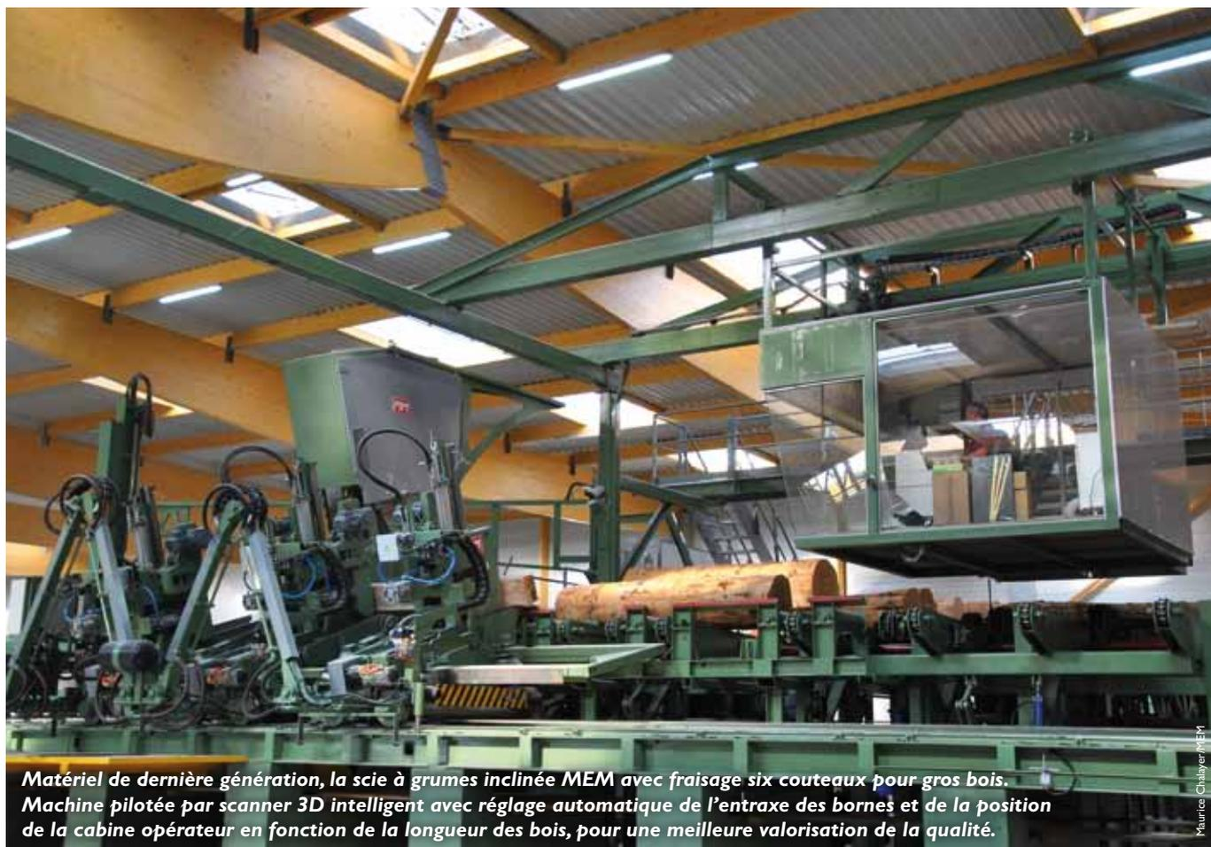
Matériel de dernière génération, la scie à grumes inclinée MEM avec fraisage six couteaux pour gros bois. Machine pilotée par scanner 3D intelligent avec réglage automatique de l'entraxe des bornes et de la position de la cabine opérateur en fonction de la longueur des bois, pour une meilleure valorisation de la qualité.
