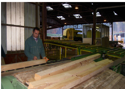
1) Marquage des défauts avec craie fluo.
