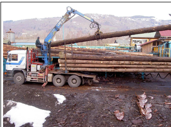
Déchargement grumes de grandes longueurs, gros diamètres, abattage manuel, résineux ou feuillu (forêts naturelles)
