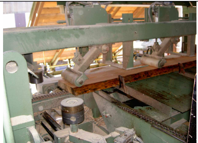
Positionnement, déligneage automatisé après prise des dimensions par le scanner
