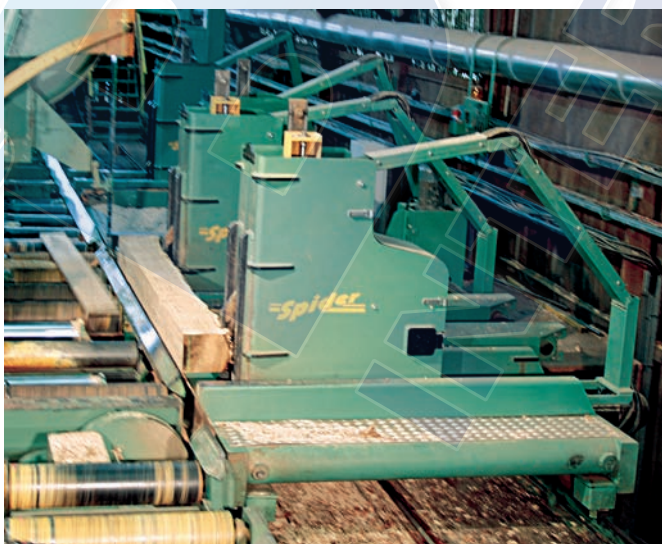
Le chariot à grumes Spider est équipé de quatre bornes indépendantes.
