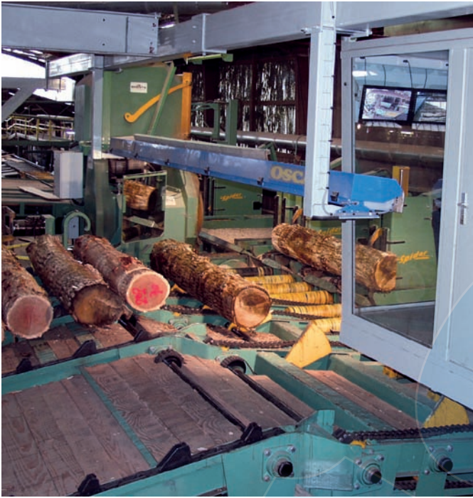
Au premier plan, le système d'optimisation Oscar propose des solutions de débits optimaux.
