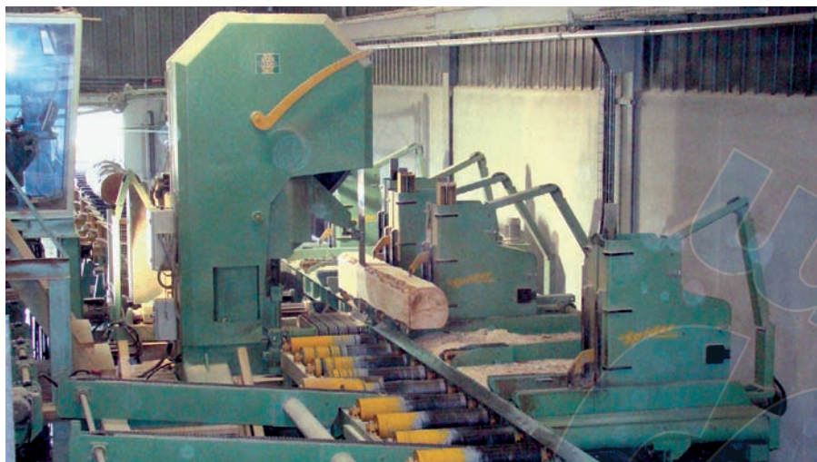
La scie à ruban est très utilisée en France pour le premier débit.
