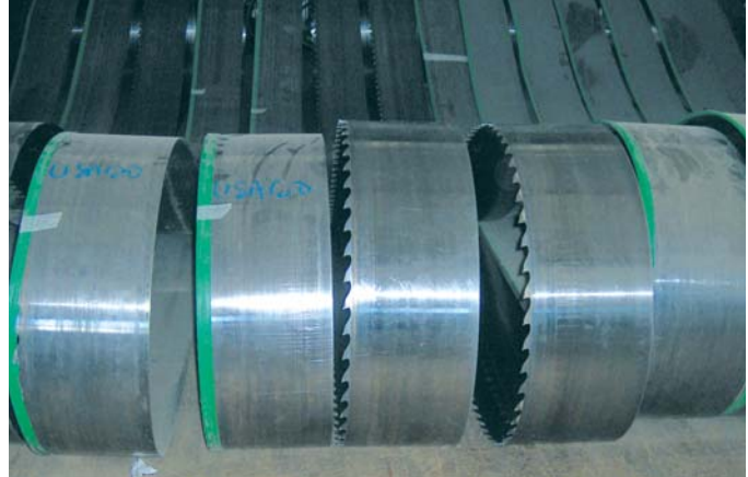
L'outil de coupe ruban est essentiellement stellite, mais aussi et de plus en plus carbure TCT.
